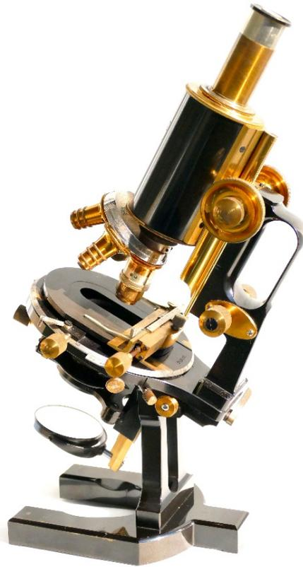
Abb. 26. Ein Zeiss "Bierseidel" Mikroskop mit dem namensgebenden Bügel, der als praktischer Handgriff diente. Das Mikroskop ist nicht nur groß (ca. 36 cm hoch), sondern auch beeindruckende 6 kg schwer.
